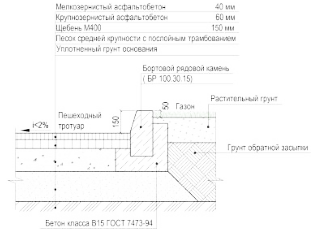
3.13.1 Схема устройства сопряжения асфальтобетонного покрытия и газона
